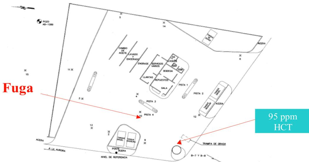
Foto No.3. Exploraciones iniciales en la gasolinera y zonas aledañas-(figura en planta)
