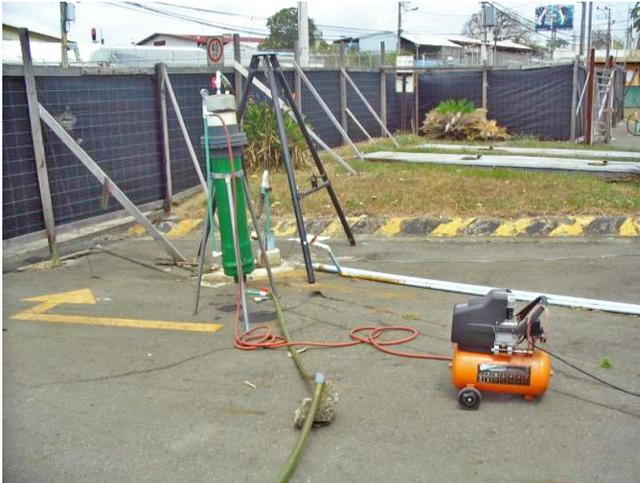
**Foto No.8.** Torre de desorción por burbujeo de aire
